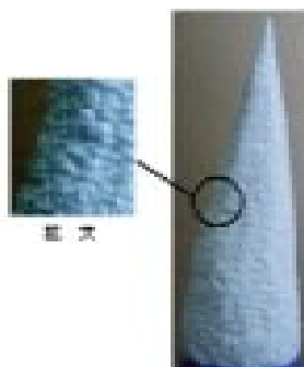
発泡スチロール原型ワイヤーブラシで軽く研磨
