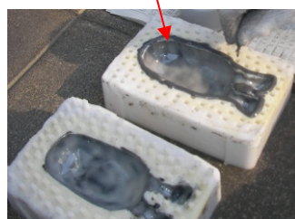
型に塗布した樹脂が半硬化または硬化後接着用として縁にウレタンマイスターを塗布します。
